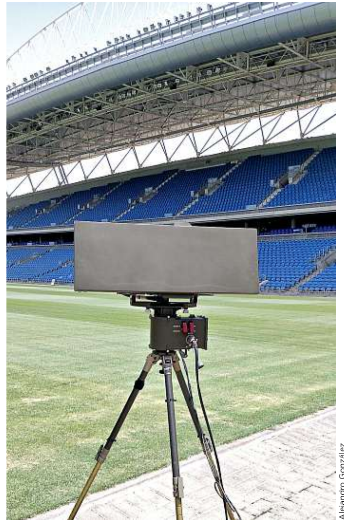
Radar que envía poderosas señales de interferencia para desactivar artefactos explosivos controlados a larga distancia.
